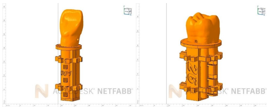
Abbildung 25: Druckbarer Frontzahn-Prüfkörper mit Beschriftung für die Variante 001 (links) und druckbare Molaren-Prüfkörper mit Beschriftung für den Zahn 26 (rechts).
